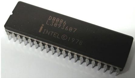
**Intel 8086:** Após o grande sucesso do processador Intel 8080™, que tornou viável a comercialização de computadores pessoais, a Intel investe em pesquisas para produzir o seu **primeiro processador com uma CPU de 16 bits**. Em 1978, o Intel 8086™ é lançado, contendo **29.000 transistores**, sua performance era 10 vezes maior que o Intel 8080™, **com frequência de 8MHz**.
